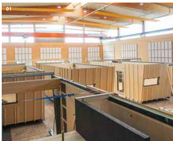
01 Kabanen Kuchelauer Hafen, Wien | Errichtung von 17 Edelbadehäusern in Modulbauweise
